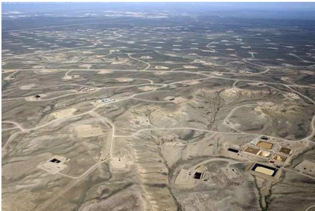
**Bild 2:** Blick auf Barnett Shale. Jede freigelegte Fläche ist für eine Bohrung oder für ein Sammelbecken für das Abwasser vorgesehen. (Quelle: [www.un-naturalgas.org/image\\_gallery.htm](http://www.un-naturalgas.org/image_gallery.htm) [8])
